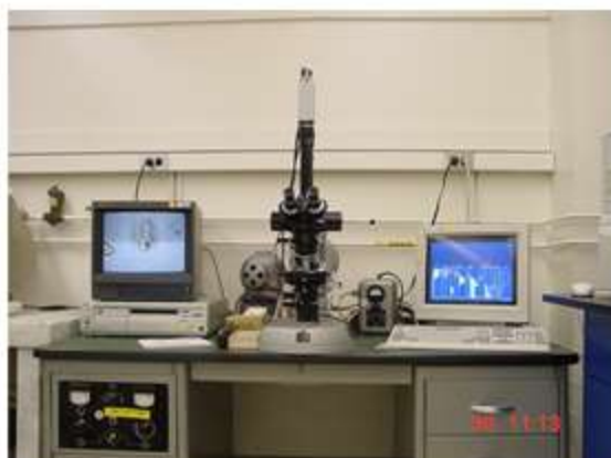
Foto 30: el microscopio que armé en la NASA sobre un Zeiss Photomat (1956) con óptica planapocromática, una pieza intermedia especial construida por American Optics sobre la que se apoya una cámara de televisión digital Pulnix con señal dividida. A la izquierda se ve el monitor SONY Trinitron de alta resolución mostrando la imagen viva, debajo está la impresora de video que produce copias fotográficas en un minuto. A la derecha una computadora dedicada con software especial para análisis de imágenes y varios programas de palinología.
